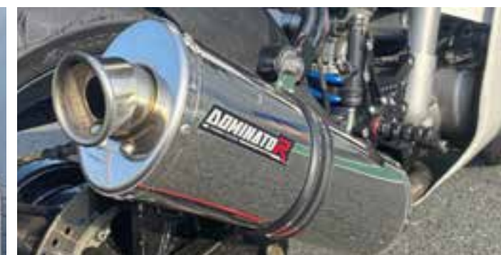
Braap-Braap: Ein Sportauspuff der Firma Dominator sorgt für kernigen Einzylindersound und ein bisschen weniger Gewicht
